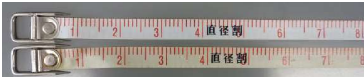
写真 3-7 直径割巻尺の伸び状況（上：新品、下：検証調査 1 年使用）
