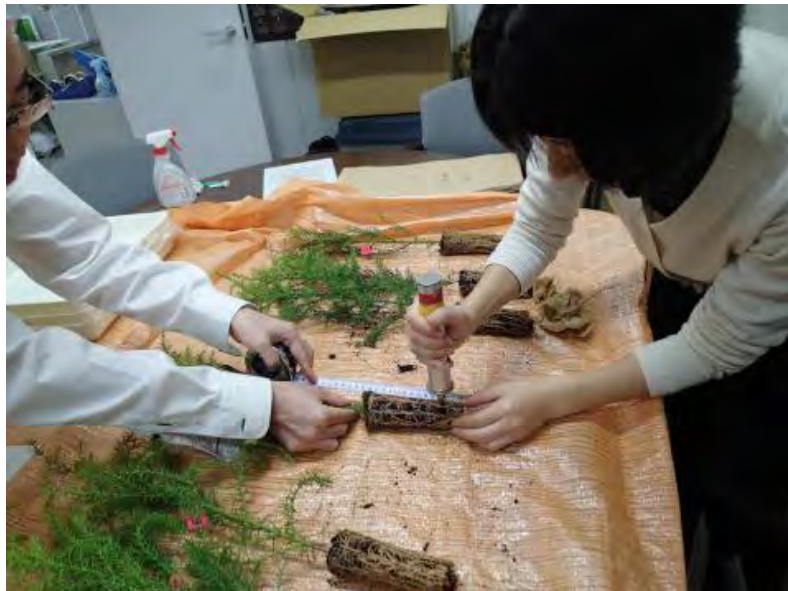
写真 3-1 根鉢の硬度計測の様子
