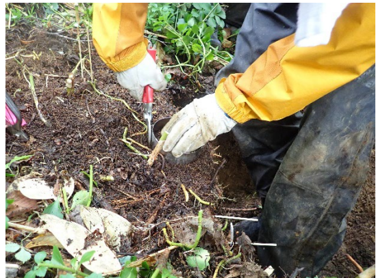
円筒を用いた定体積試料採取の実演
