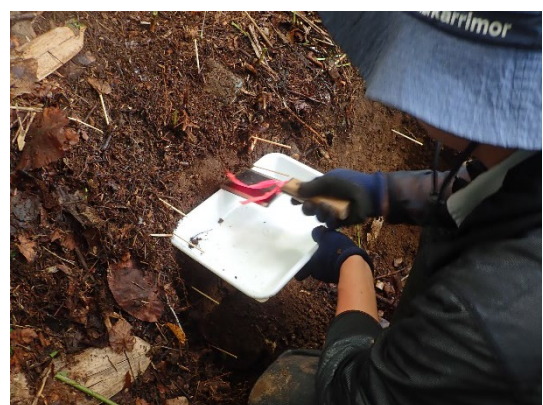
急傾斜地における化学分析用試料の採取
