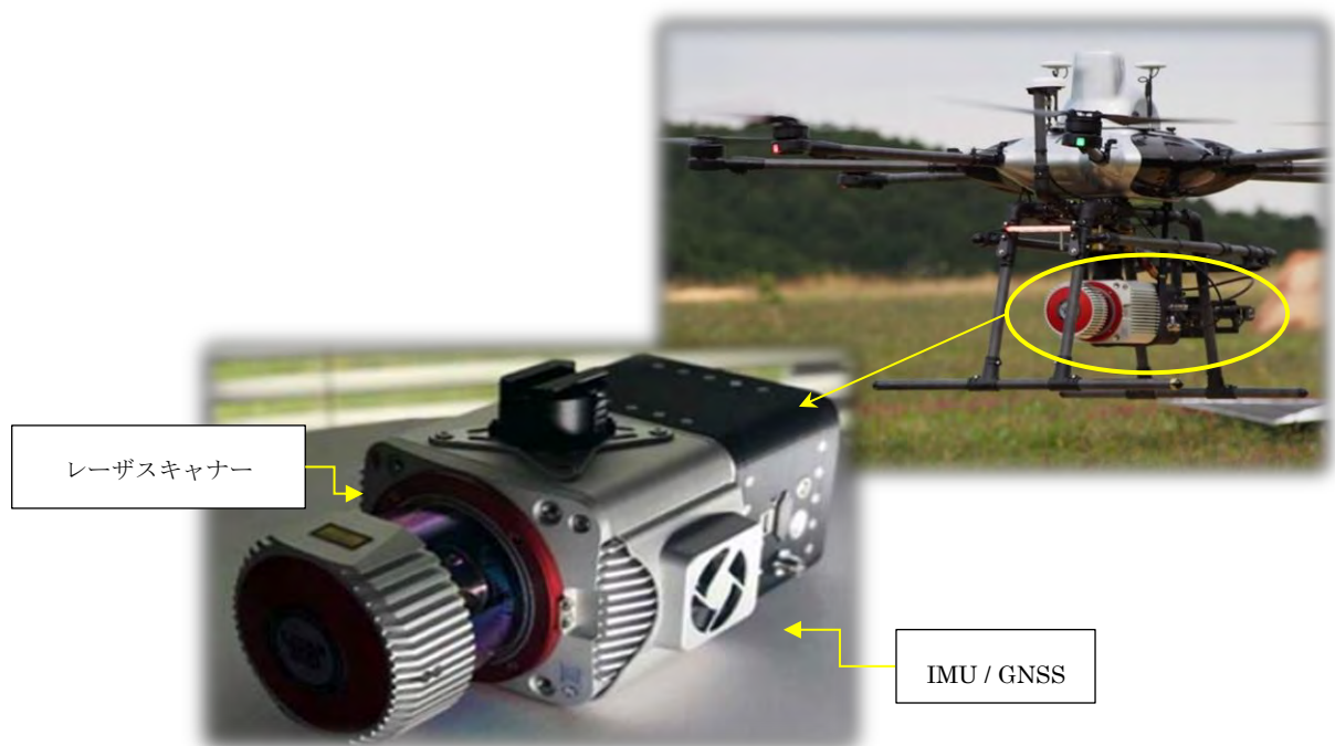
図 2.4 UAV レーザ計測機器
