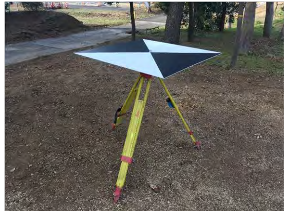
図 2.6 調整点関係機器(左図：観測風景 右図：対空標識設置風景)
