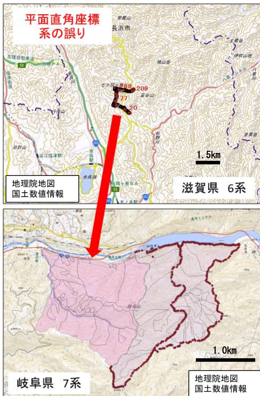
図 4.2-4 異常個所の事例（岐阜県 川上地区）
