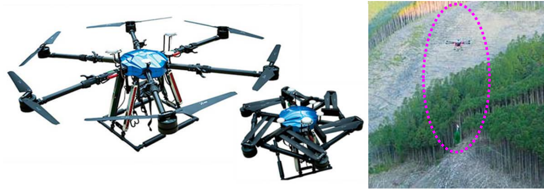
図 2. 5.2 苗木運搬 UAV「No.1 いたきそ」機体（左）と苗木運搬状況（右）（FOREST JOURNAL vol.5（2020 年秋号）に加筆）
