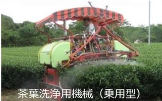
露地野菜洗浄用機械（乗用型）      茶葉洗浄用機械（乗用型）
