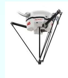
小さな作業領域で高出力かつ高精度で製品をピック&プレースできるロボット
