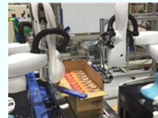
商品の包装工程において、箱詰めから封函まで自動で行うロボット
