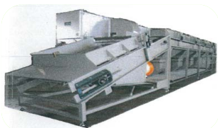
効率的な抹茶生産のための 新型てん茶炉（茶葉処理加工施設）
