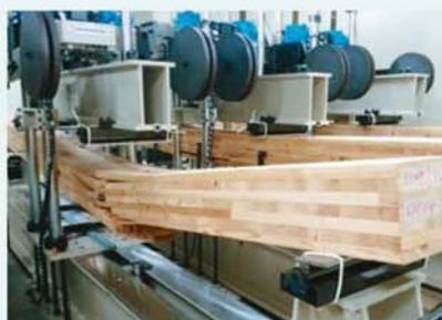
CLT(直交集成板)など新しい木質材料の性能評価
