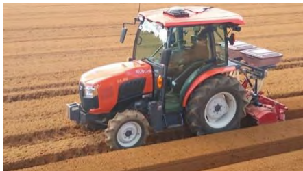
直進アシスト機能付き トラクタによる畝立て実証
