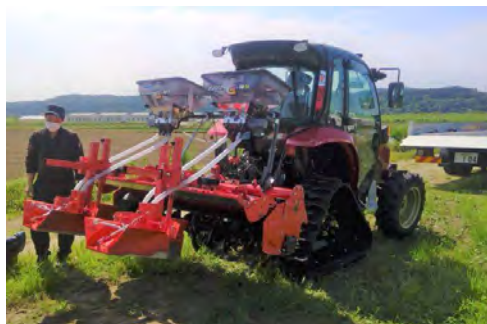
直進アシストトラクター ＋施肥同時溝掘アタッチ
