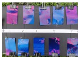
図5 感水紙による薬剤の付着評価
