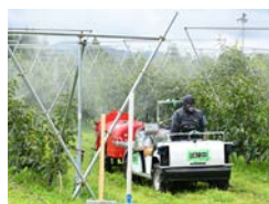
図4 自動走行車による農薬散布作業
