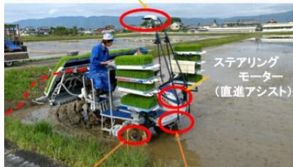
電圧センサー(2種類)(肥沃度) 測距センサー(作土深)
