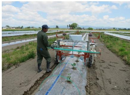
トンネル支柱打込機による打込作業
