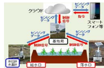
ほ場水管理システム
