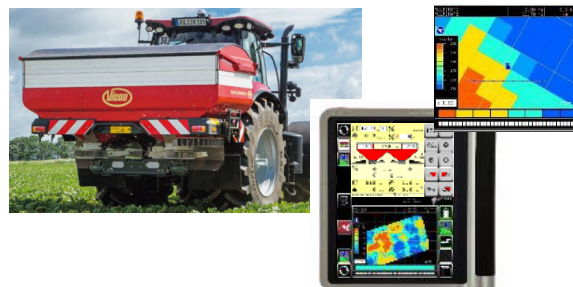
施肥マップに基づく可変施肥 （化学肥料の使用低減）
