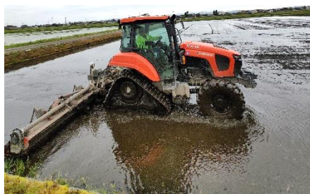
自動操舵トラクターによる代掻作業
