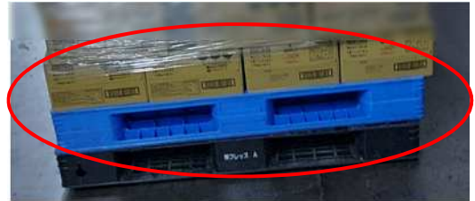
ラッピングが下部まで施されていない。
