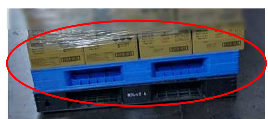
ラッピングが下部まで施されていない。
