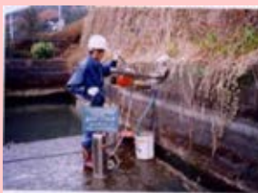
コア採取による強度測定
