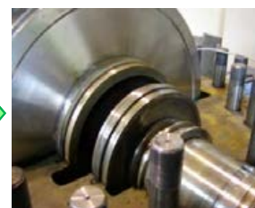
補修後（研磨、欠損部の補修等）
