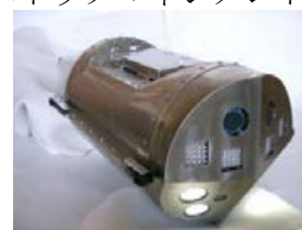
撮影ロボットによるトンネル内調査
