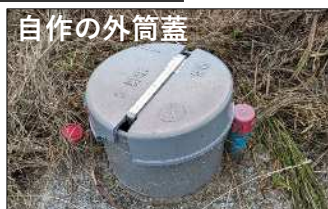
端材のエンドキャップを切り欠き加工
