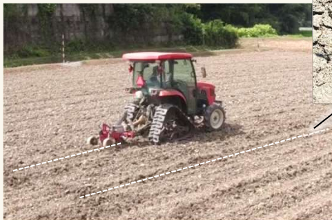
サブソイラーによる補助孔の施工
