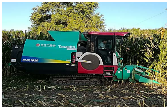
四国でも数少ない汎用型微細断飼料収穫機
