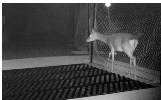
コンクリートの路肩部分に肢を置いて通過
