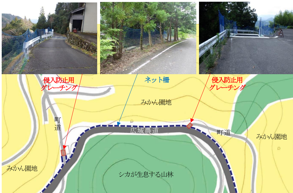
みかん園地における侵入防止用グレーチングの設置位置
